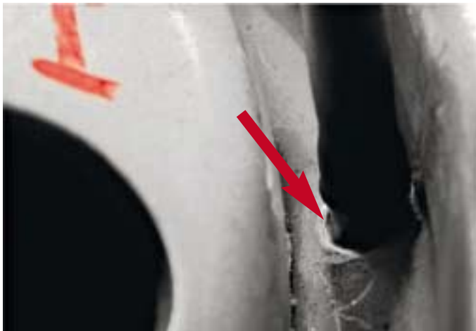
Bei zu kräftigem Einziehen des Vollgummi-Ventils in die Bohrung ...
