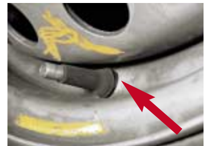
Nicht gestellt, sondern real: Stellung des TR-414-Ventils nach plötzlichem Druckverlust
