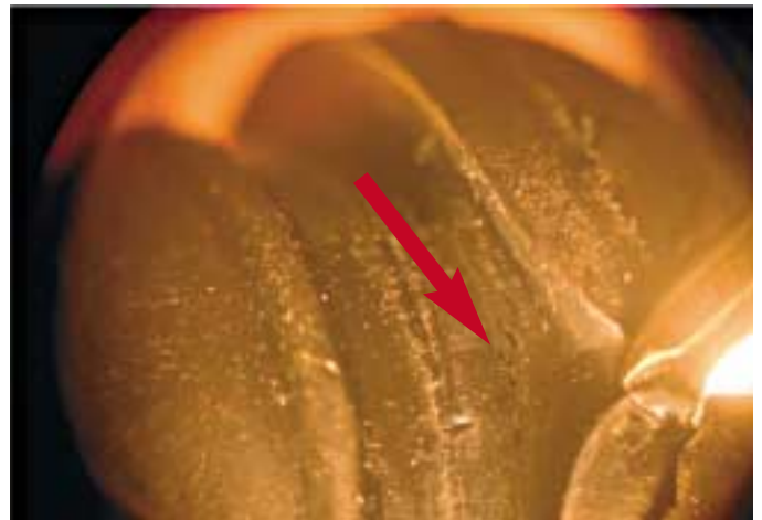
... kann durch Überdehnung ein Anriss des Ventilfußes entstehen
